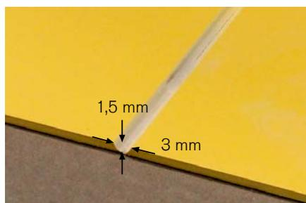
3. Frässpäne entfernen (absaugen).
