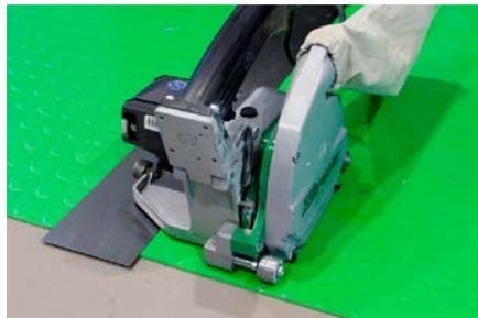
4. Frässpäne entfernen (absaugen).
