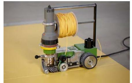
5. Die Verarbeitungstemperatur liegt bei 350–400°C. Beim Verarbeiten der Thermoschnur mit Schweißautomaten ist die Geschwindigkeit auf ca. 2 lfm/Min. einzustellen. Die Laufgeschwindigkeit und Temperatureinstellung kann bei den meisten Automaten reguliert werden.
