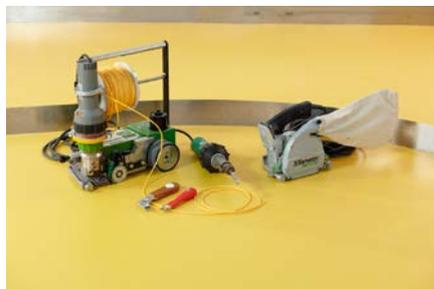
1. Die Fugen werden mit der Fugenfräse und/oder dem Fugenzieher mittig ausgefräst bzw. aufgezogen.
