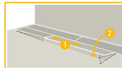
3. Bei den folgenden Dielen verbinden Sie zunächst die kurze Seite, dann die Längsseite, indem Sie die Diele anwinkeln.
